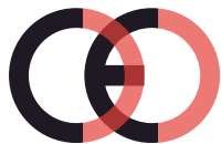
Falsche CE-Kennzeichnung (zu dicht)
