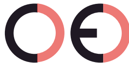
Falsche CE-Kennzeichnung (zu großer Zwischenraum)
